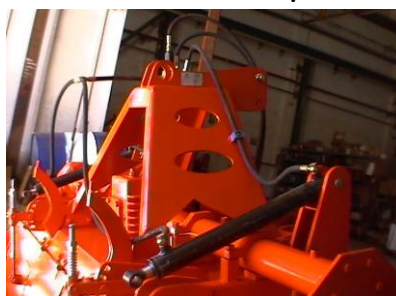
Tureta intarita si sistem hidraulic
